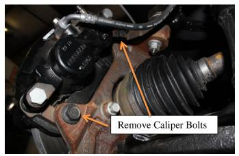
DO NOT ALLOW THE BRAKE CALIPER TO HANG FROM THE BRAKE LINE HOSE
