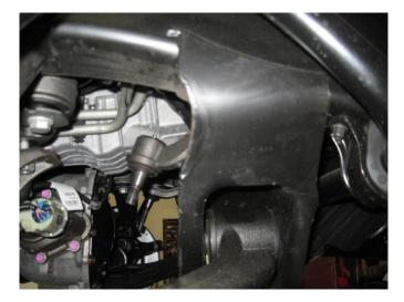
**GRIND FRAME FOR STEERING CLEARANCE**
