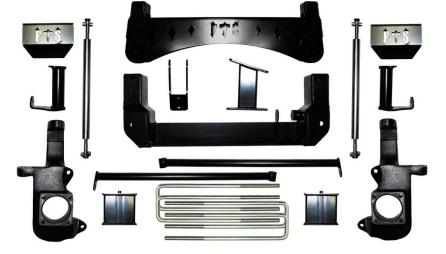
C8510-4 MAIN BOX KIT W/ HARDWARE 1) FRONT X MEMBER 1) REAR X MEMBER 2) TORSION BAR DROPS 1) LEFT BUMP STOP 1) RIGHT BUMP STOP 2) SWAY BAR END LINKS 1) DRIVER DIFF DROP 1) PASSENGER DIFF DROP 1) HARDWARE
