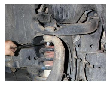
8) Loosen outer tie rod nut.
